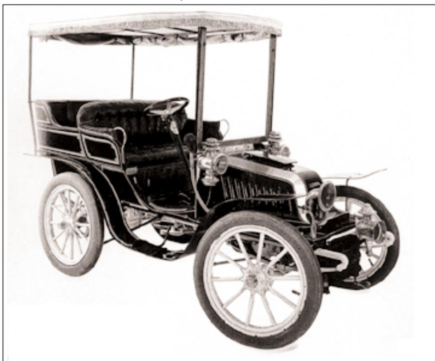
Padova), è dotata di un motore monocilindrico orizzontale avente alesaggio di 85 mm e corsa di 110 mm, per una cilindrata di 625 cm<sup>3</sup>; il motore sviluppava una potenza di 1.72 kW (2.34 CV) al regime nominale di 770 giri/minuto; la velocità di rotazione poteva variare tra 420 e 820 giri/minuto; il veicolo raggiungeva una velocità di 35 km/ora.
