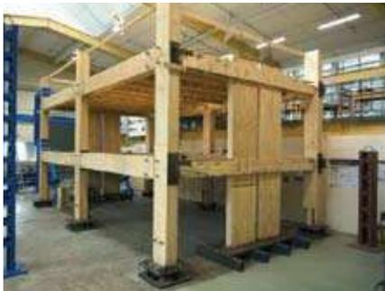
Fig. 13 - Prove di laboratorio sul sistema Press-Lam presso l'Università di Canterbury (Nuova Zelanda)
